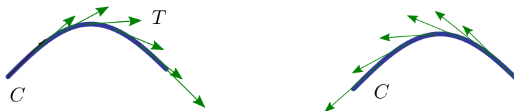
Figura 7.12: Orientación inducida por dos parametrizaciones.
